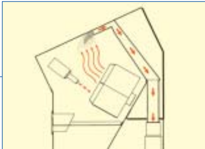
Lage und Ausführung des Absaugkanals
